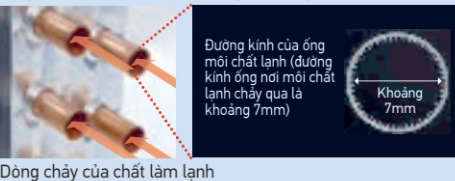
Dòng chảy của chất làm lạnh
