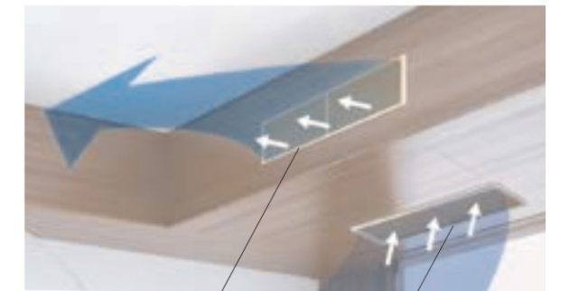
Miệng gió cấp
